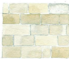
Appareillage régulier en pierre de taille, montées à sec ou à joints fins.
