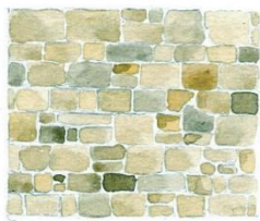
Appareillage régulier en moellons équarris, montés au mortier de chaux.
